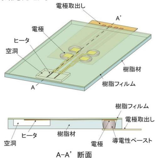
自動車、航空機など、流体中を運動する物体表面に作用するせん断力を計測する熱式 MEMS センサを提案しています。
