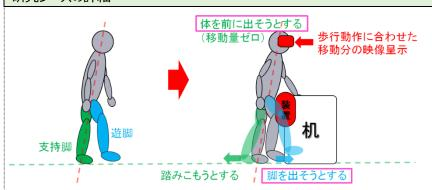
大腿部支持部に載置された荷重センサによって進行方向への歩行動作 (体のもたれ具合、足の動き、歩行リズム、歩行バランス等)を推定し、 HMD等の視覚ディスプレイを介して歩行動作に応じた映像を呈示することにより、簡易な仕組みで歩行感覚を定位置で呈示することが可能です。
